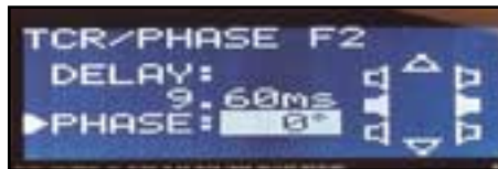
Graf Zahl: Zentimetergenau lässt sich per „Praxis“ die Laufzeit des Subs einstellen.
