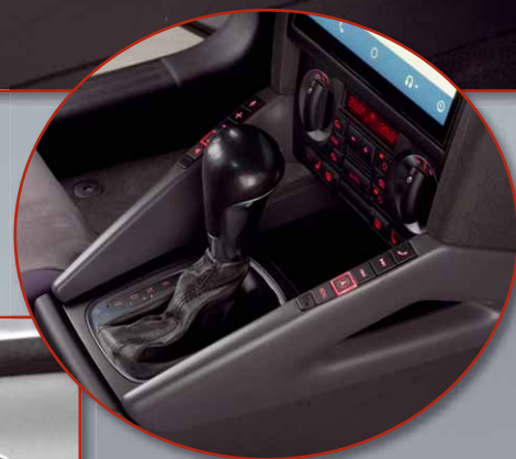
Das Alpine-Freestyle-Gerät lässt dem Einbauer alle Freiheiten, die Tasten sind flexibel platzierbar
