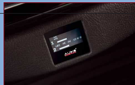
Das DSP-Display ist separat eingebaut und hübsch integriert. Der zugehörige Bedienregler wandert neben den Automatikhebel
