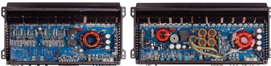
Reichhaltige Bestückung und solider Aufbau bei beiden Verstärkern, u.a. mit groß dimensionierten Netztrafos
