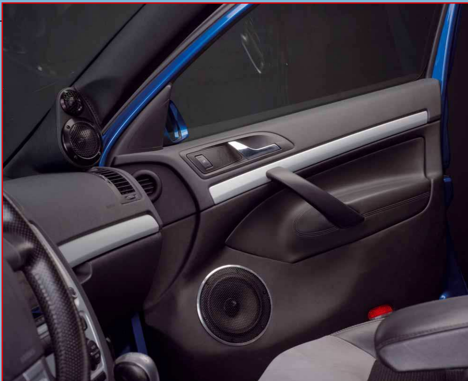
Die Türen wurden neu aufgebaut, um den Tieftöner akustisch günstig zu positionieren
