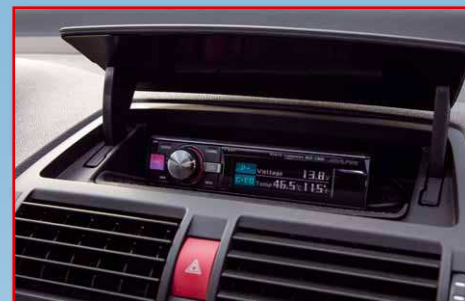
Das Bedienteil des Prozessors sitzt unter der Klappe im Armaturenbrett
