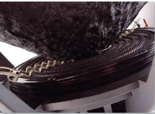
Zwie Zentrierspinnen werden mit einem Kunststoffstufung voneinander getrennt, die obere trägt die Zuleitungslitzen zur Spule
