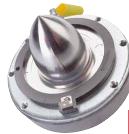
Der 20-er-Tiefmitteltöner gerät schlank und luftig, auch der Antrieb macht sich dank Neodym klein
