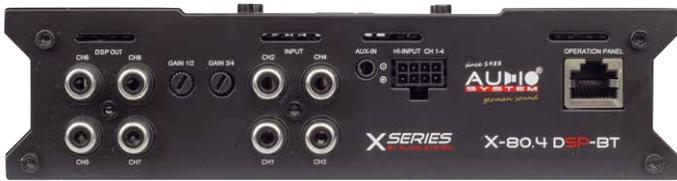
4 prozessierte Ausgänge und der Klinkeneingangs- verraten die DSP-End- stufe, ansonsten ist alles X-80.4 D
