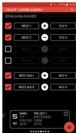
Mixer: Unten der einzustellende Ausgang, oben die Eingänge mit ihren Anteilen
