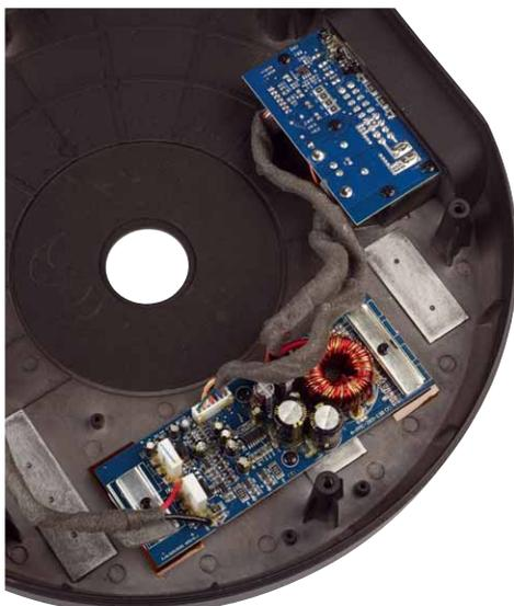
Eine kleine Analogendstufe versorgt den Woofer mit Leistung
