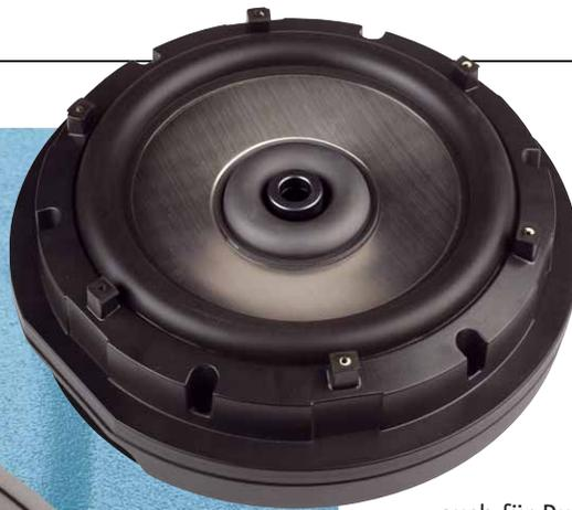
Unter dem Bodengitter verbirgt sich ein 11"-Woofer mit stabiler Alumembran. Statt Dustcap hat er eine Sicke zur Abdichtung in der Membranmitte, um die durchgängige Bohrung zu erhalten
