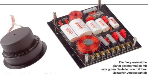
Unter der Abdeckkappe verhilft ein Koppelvolumen dem Hochtöner zu einer Extraportion Schalldruck am unteren Übertragungsende
