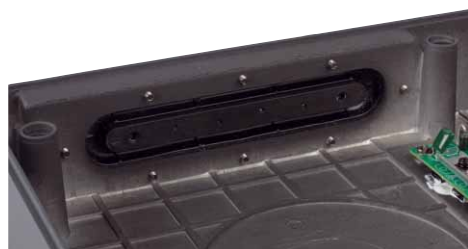
Der Clou am Gehäuse sind sie beiden Passivmembranen an den Seiten
