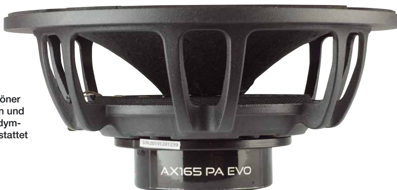
Der 20-cm-Tieftöner läuft auch unbeschaltet recht gutmütig mit dem für die große Membran typischen Schalldruckabfall unter Winkel. Unterhalb von 80 Hz tut sich nicht mehr viel
