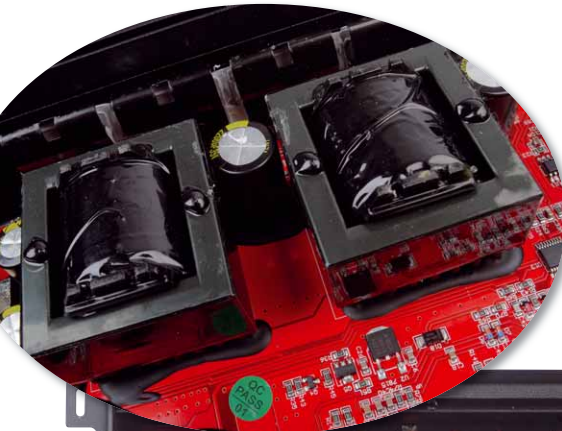
Die Übersetzung des Doppelnetzteils entscheidet über 12 Volt oder 24 Volt Eignung, die Verstärkung danach ist gleich
