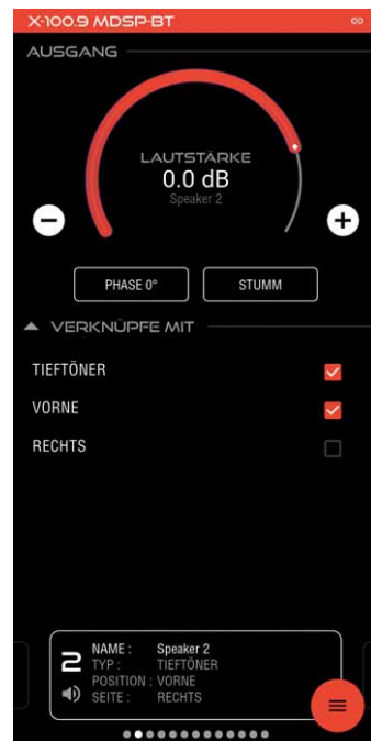
Unter Ausgang werden Polarität, Stummschaltung und individuelle Pegel geregelt
