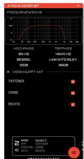
Die Frequenzeinstellung lässt keine Fragen aufkommen, es gibt Hochpass und Tiefpass als Butterworth, Bessel oder Linkwitzfilter
