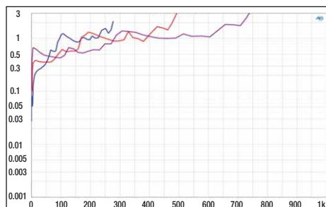
Die H-1600.4D 24V pendelt bei mittleren und hohen Leistungen um die 1 % Marke, was unsere Leistungsangaben etwas knifflig macht
