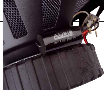
Beim RXC ist der Kondensatorwert wie der Tweeter eine Nummer größer
