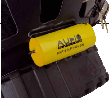
Auch der MXC filtert mit einem MKP Folienkondensator
