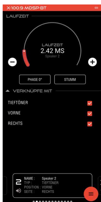
Die Laufzeitkorrektur wird in Millisekunden, Zentimetern oder Samples angezeigt, auch hier gibt es Buttons für Stummschaltung und Umpolen
