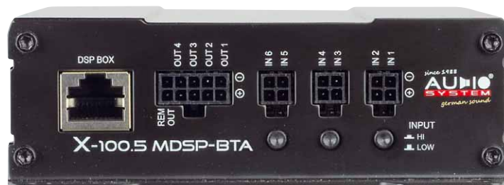
Die drei Paar Eingänge lassen sich mit drei Schaltern von High auf Low-In umschalten
