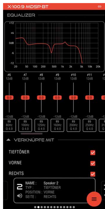
30 vollparametrische Bänder pro Kanal bieten alle Schikanen, im Diagramm sieht man auch die Frequenzweichen
